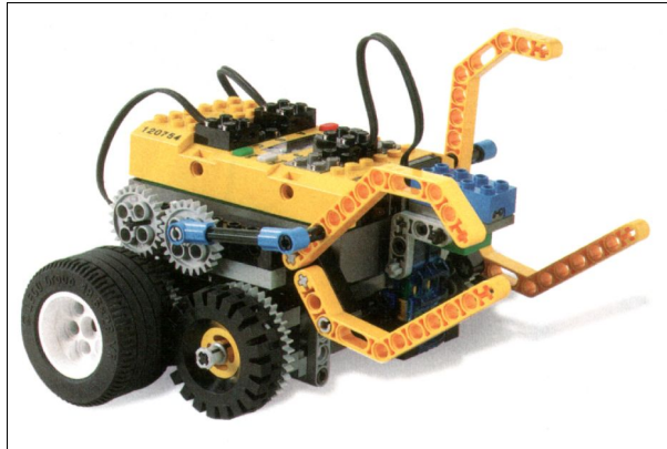
Abbildung 1.3: Mobiler Roboter, mit dem Lego Robotics Invention System gebaut
