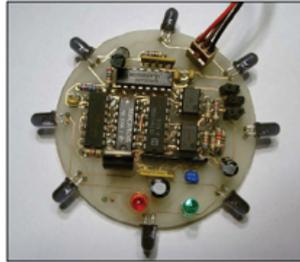
Abbildung 7.1.: IR-Beacon für die Tor Erkennung
