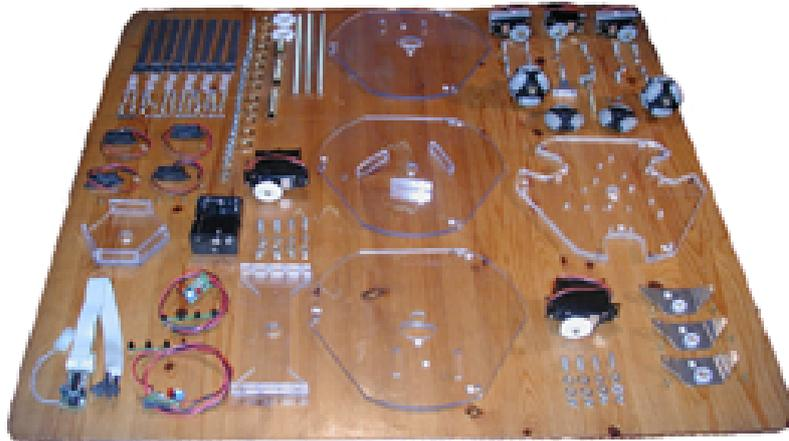
Abbildung 8.8.: Einzelteile der Roboterplattform
