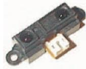
Abbildung 7.4.: Sharp Entfernungsmesser der Serie GP2D1xx
