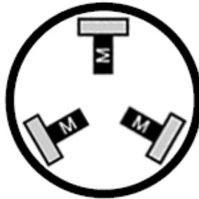
Abbildung 3.6.: “Omnidirectional“-Antrieb
