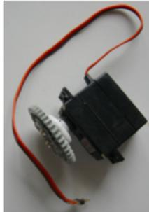
Abbildung 7.3.: Servomotoren; Umbaubar zu einem Antriebsmotor
