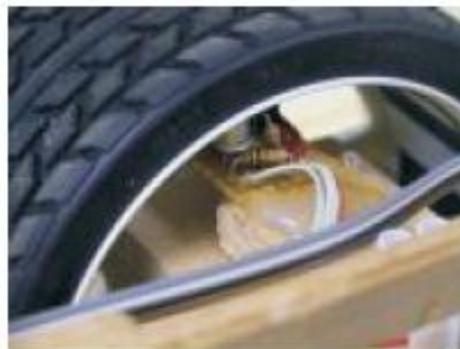
Abbildung 7.12.: optischer Radencoder (Photoreflektor)
