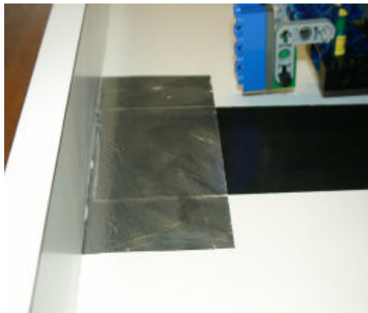
Abbildung 8: Endpunktmarkierung mit Lichtsensor
