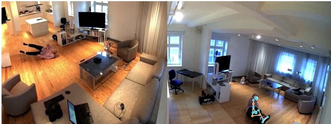
Abbildung 6.2: Aufnahme derselben Situation mit den Domkameras 1 und 6, vgl. Abbildung 5.4. Links: Kamera 6, keine Sturzmeldung aufgrund fehlender Pose Estimation. Rechts: Kamera 1, Pose Estimation erfolgreich, Sturz wird erkannt.
