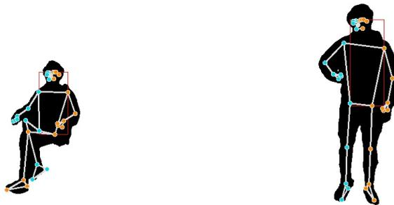
Abbildung 4.3: Zwei Bilder die mittels Segmentierung aufbereitet wurden und so an das ResNet50 übergeben werden. Links: Sitzend, rechts: Stehend.
