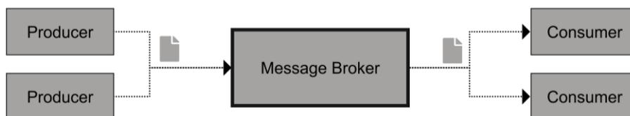
Abbildung 6: Schematische Darstellung eines Message Brokers
