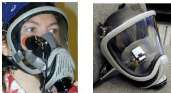
Abbildung 2.1: Sauerstoffmasken mit integriertem Display
