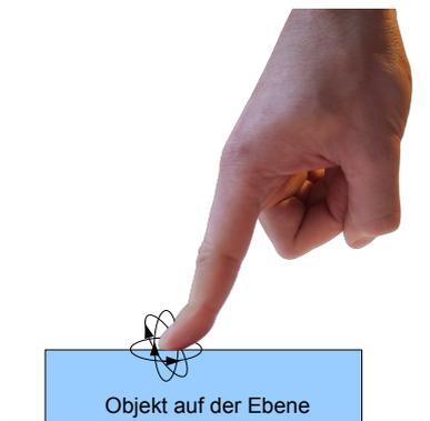
Abb. 4.2: Die drei Freiheitsgrade der Fingerspitze bei einem Kontaktpunkt.
