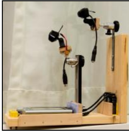
Abbildung 3-1 Labor zur Untersuchung der Softwareergonomie von mobilen Geräten
