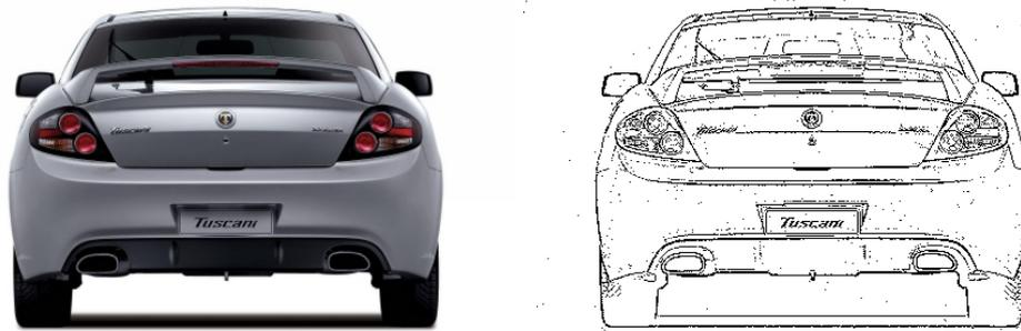
Abb. 5: Anwendung des Laplace Operators auf ein Grauwertbild mit künstlicher Rauschstörung
