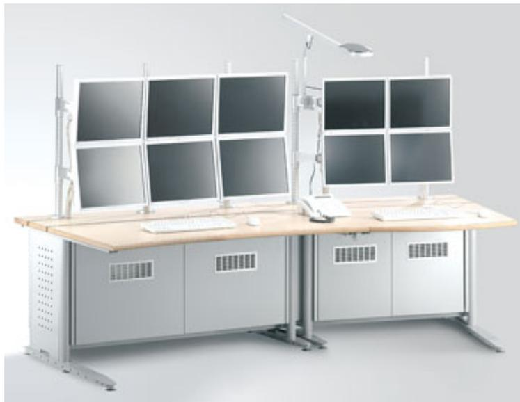
Abbildung 2.2: Leitstand mit mehreren Monitoren. [Rohde, 2007]
