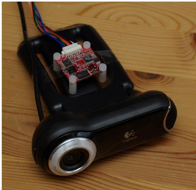
Abbildung 1: USB-Kamera mit montiertem Kompassmodul
