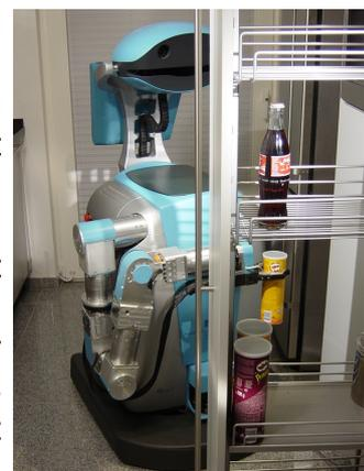
Abbildung 2: Care-O-bot® des Fraunhofer IPA beim Greifen einer Dose
