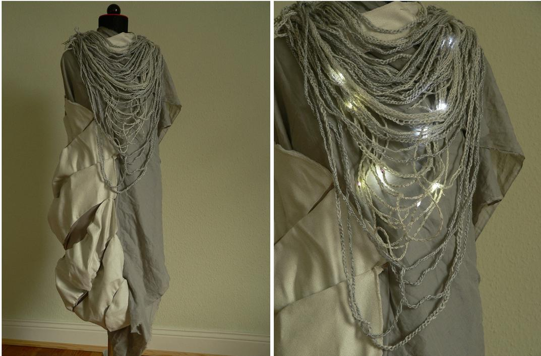
Abbildung B.6.: LEDs pulsieren zum Herzschlag des Trägers
