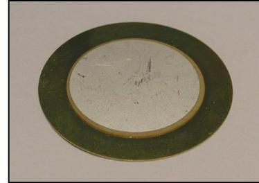
Abbildung 16: Ferroelektrischer Lautsprecher
