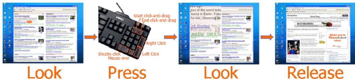
Abbildung 4.2: Ablauf der Selektion bei der 'EyePoint'-Technik [Kumar u. a. 2007]
