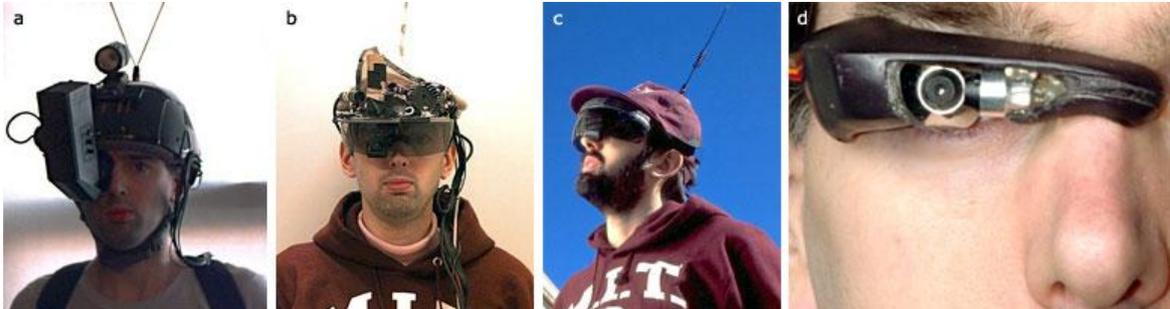
Abbildung 2.2: Steve Manns Entwicklungen von Anfang der Achtziger Jahre. Abb.(a bis c) zeigen Helmdisplays inklusive Antennen. Abb. (d) ist ein „EyeTap“ Display [Reasearch 2008]
