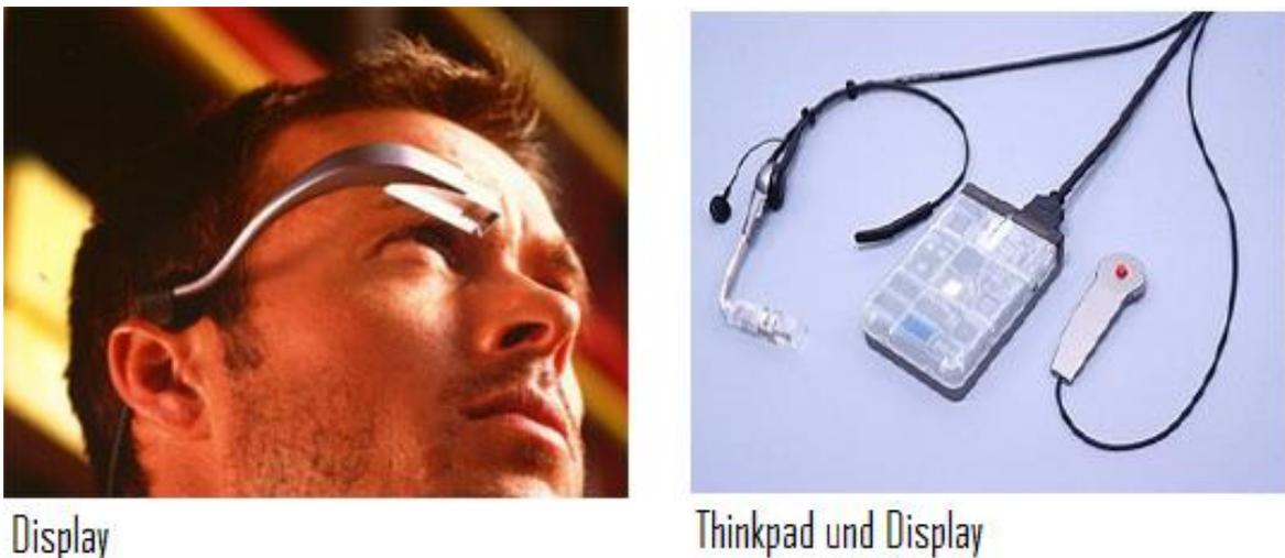
Abbildung 2.3: Head Mounted Display von IBM mit dem Wearable Thinkpad [Wilcox 2008]
