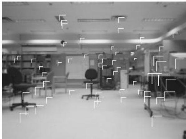
Abb. 4: Ergebnisse des Stereo-Abgleichs. Die Längen der Linien symbolisieren die horizontale und vertikale Disparität der Punkte. Daraus ergibt sich der Abstand des Punktes zum Kamerasystem. Nahe Objekte haben längere Linien.
