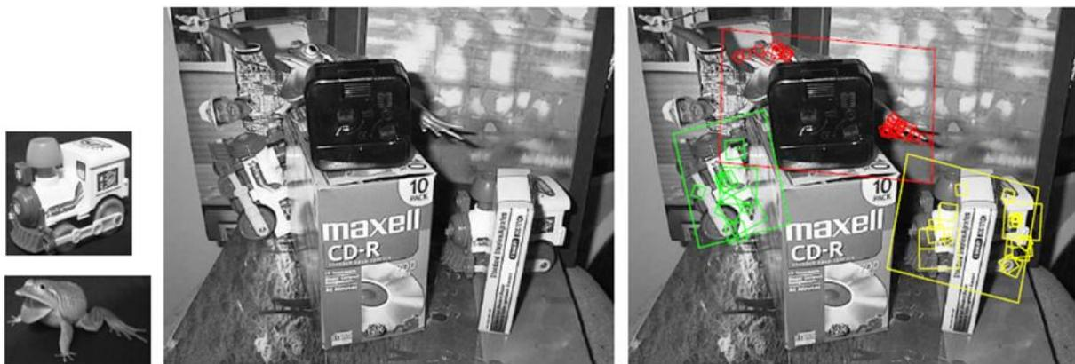
Abb. 2: Beispiel einer SIFT Anwendung - Links sind zwei Referenz-Abbildungen zu sehen. In der Mitte sieht man das Vergleichsbild, in dem die Objekte gefunden werden sollen. Auf der rechten Abbildung wurden die gefundenen Objekte markiert. Die kleinen Rechtecke verweisen auf die Key-Points, die zur Identifikation dienen.
