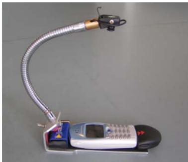
Abbildung: Mini-Kamera mit Barcode Scanner [Nielsen et al.]
