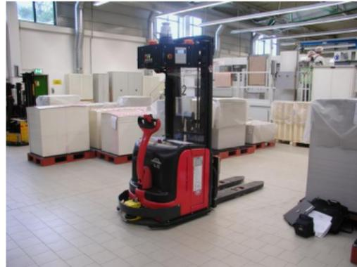
Abbildung: Autonome Fahrzeuge ausgerüstet von E&K Automation
