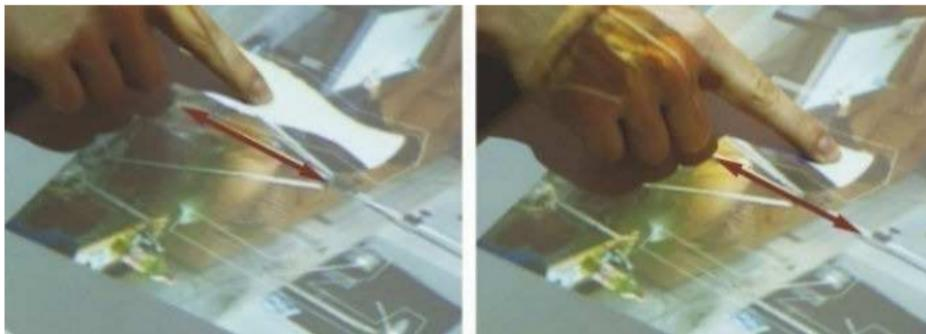
**Abbildung:** Finger über die Lampe schieben, um diese zu dimmen
