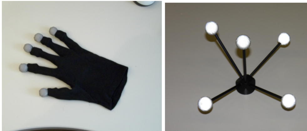
Abbildung 3.1: : Links - Handschuhe Rechts - ART-Tracker-Artefakt
