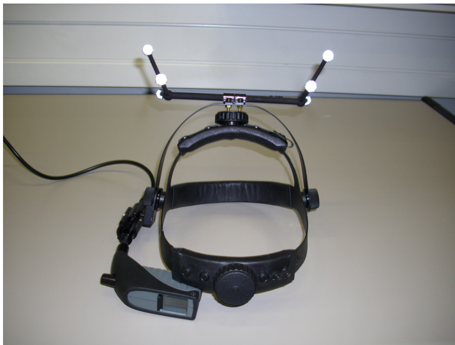
Abbildung 3.2: Headup-Display mit Art-Trackerartefakt
