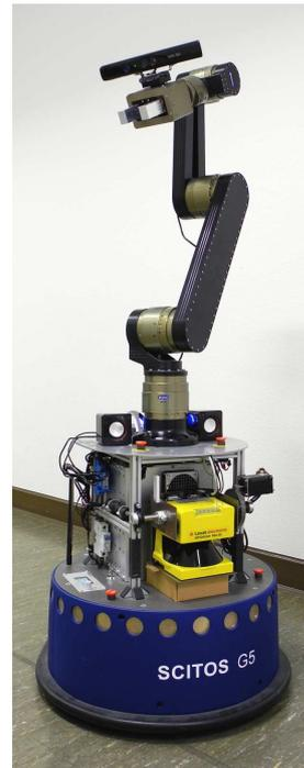
Abbildung 1: Roboter im Robot Vision Labor
