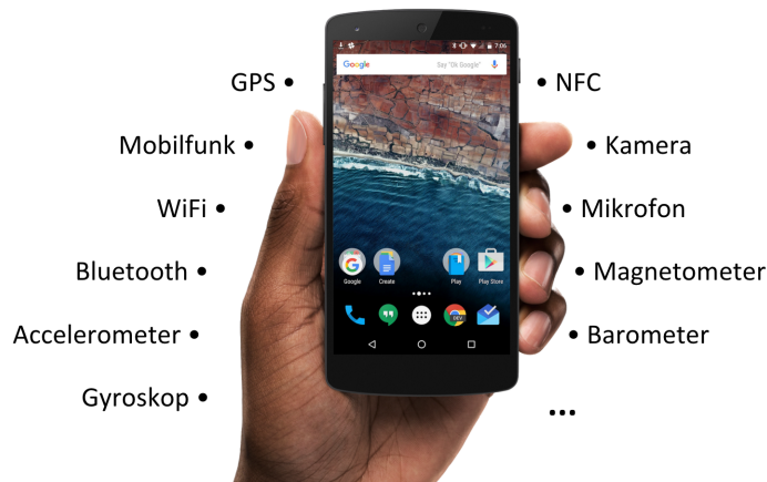
Fig. 1: Im Smartphone verbaute Sensoren [Eigene Darstellung auf Basis von Handskit 4 ]
