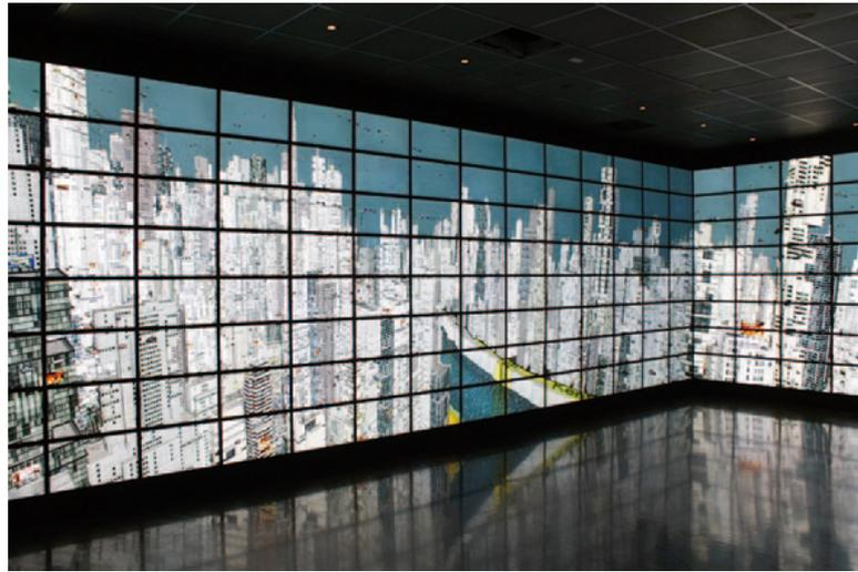
Abbildung 4.3: Tiled Wall aus Monitoren am Beispiel des Stony Brook's Reality Deck ([Dörner u. a., 2013, S. 136](#))
