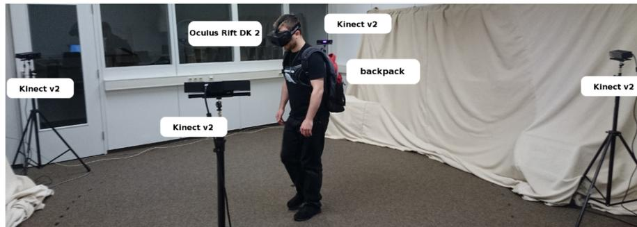
Fig. 10: Laboraufbau: Der Nutzer trägt eine VR-Brille mit einem Notebook im Rucksack. Dabei wird er von vier Kinects v2 getracket [19]
