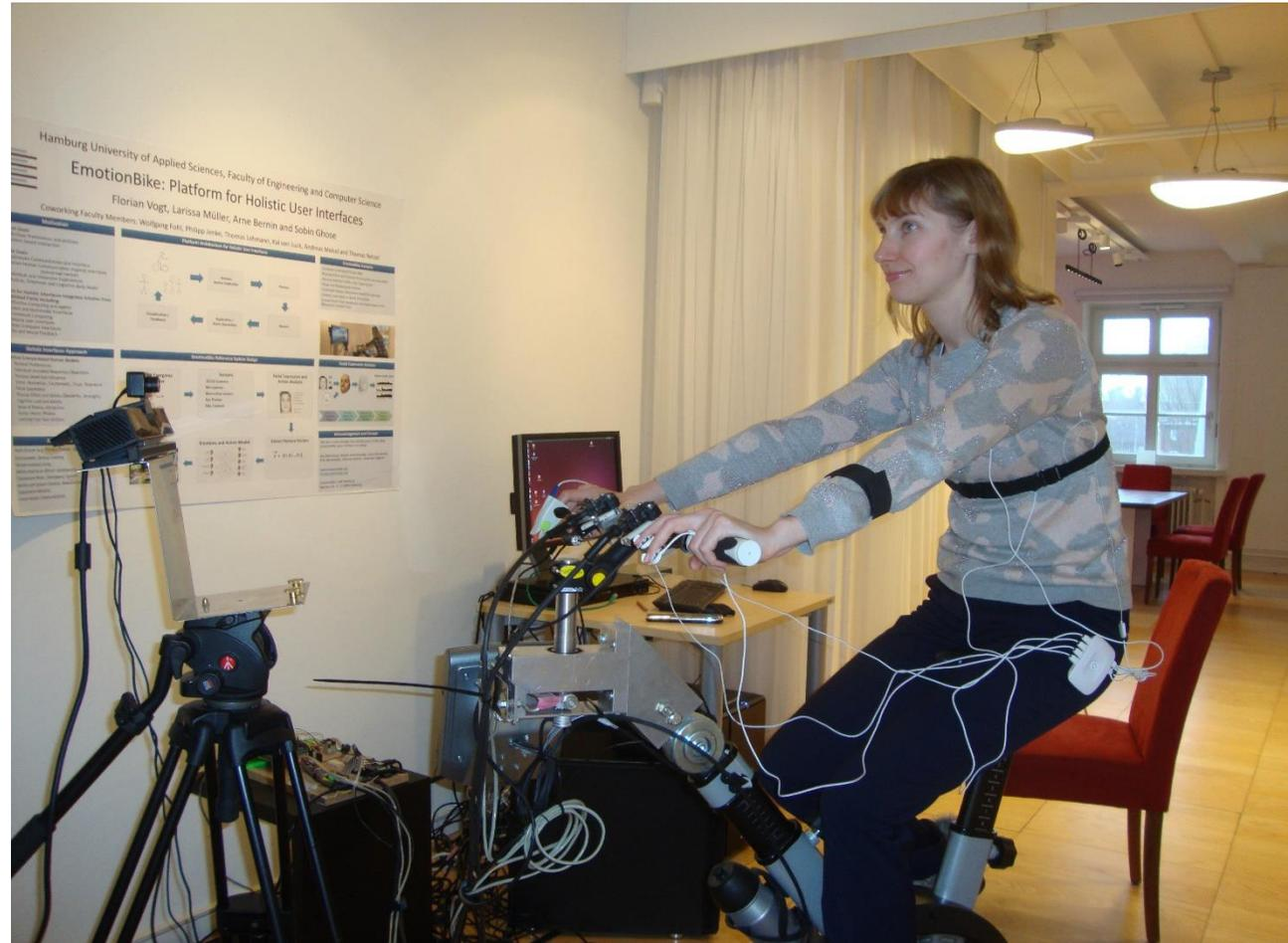
Emotionserkennung mittels Bio-Sensoren
