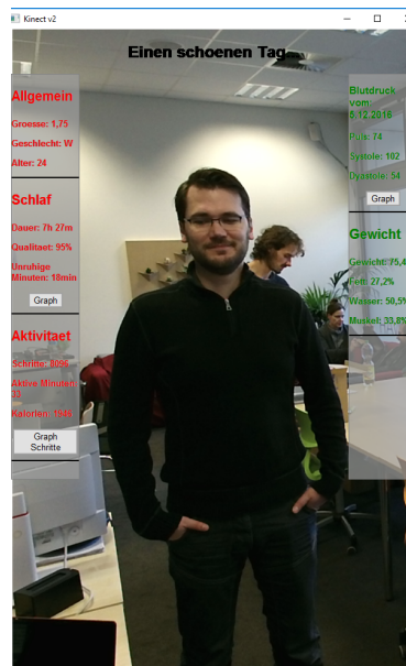
Abb. 4. Abbildung des aktuellen Prototyps des intelligenten Spiegels
