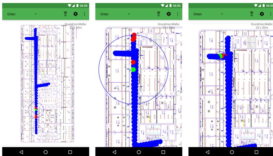
Fig. 3: Ortung mit wechselnder Genauigkeit in der IndoorGPS Smartphone App
