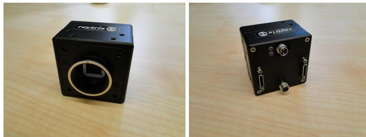
Abb. 1: Front- (ohne Objektiv) und Rückansicht der Raytrix Lichtfeldkamera
