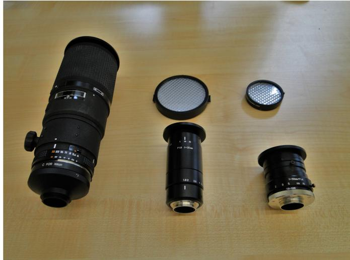
Abb. 5: Objektive der Raytrix Lichtfeldkamera inkl. montierter Filtergewindeadapter und dem Kalibrierungsfilter (v. l. n. r. NIKON 200 MM, KOWA LM25SC, KOWA LM50HC)
