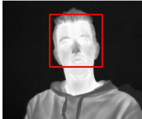
Abb. 15: Thermalbild Tracking mit „haarcascade_frontalface_default.xml“
