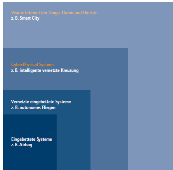
Abb. 1. Aufbau von eingebetteten System zum Internet der Dinge [8]
