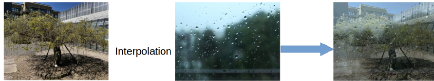
Abb. 6. Die Interpolation um Regeneffekte auf das Bild zu bekommen. Links ist das Originalbild und mittig das von Pixabay[10] heruntergeladene Bild mit der verregneten Scheibe. Rechts ist das Ergebnis der Interpolation
