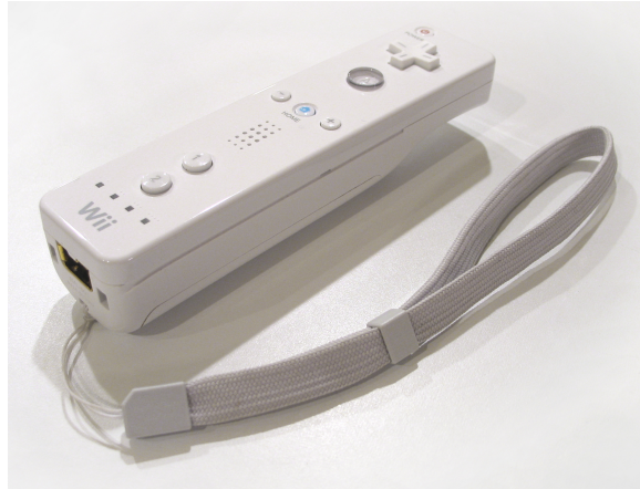
Abbildung 2.4: Die Wii Remote nutzt unter anderem Bewegungssensoren
