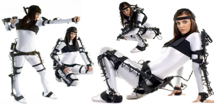
Abbildung 4.2: Gypsy Motion Capture System: Model Gypsy 6 (Gmitterko)
