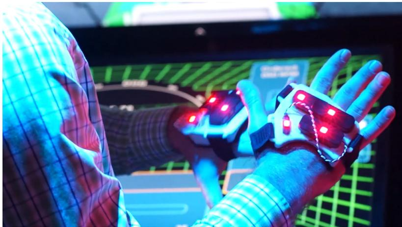
Abbildung 4.5: PhaseSpace Motion-Capture-System mit Aktiven Markern (PhaseSpace)
