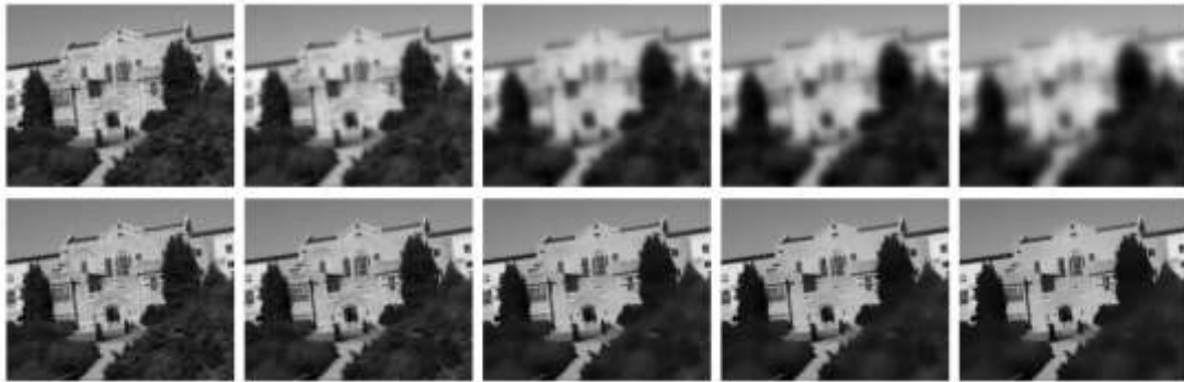
Abbildung 10 Oben: Gaußscher Scale Space (linear). Unten: Nonlinear Diffusion Scale Space.
