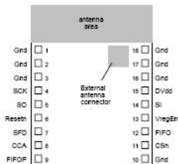
Abbildung 5.7: Schematik des EasyBee Modul der Firma Flexipanel
