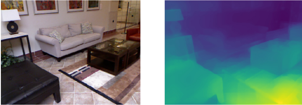
Abbildung 5.7: RGB-Bild und Original Dense Depth Prediction
