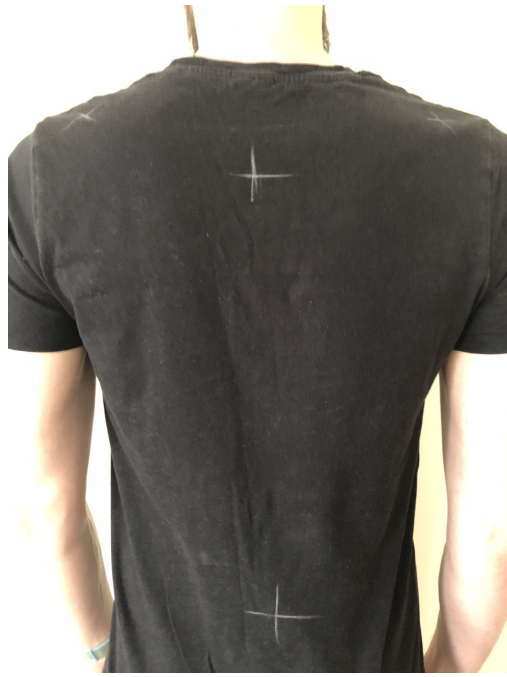
Abbildung 3.9: Angezeichnete Positionen der Aktuatoren auf dem T-Shirt des Fitness Wearables
