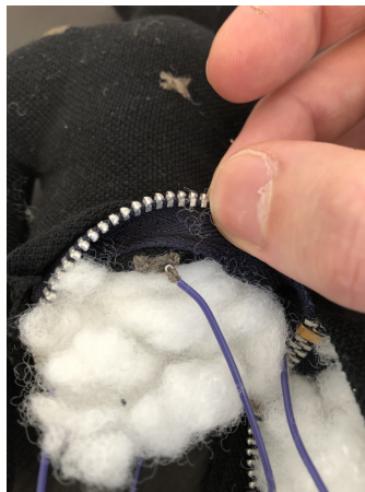
Abbildung 4.4: Verkabelung der Sensorflächen zum Mikrocontroller des Subsystem Puppe
