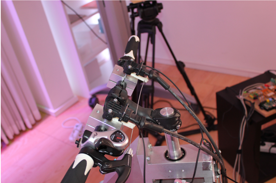
Abbildung 2.2: Der Lenker, die Gangschaltung und die Bremse sind über Bremszüge mit dem Potenziometern verbunden.
