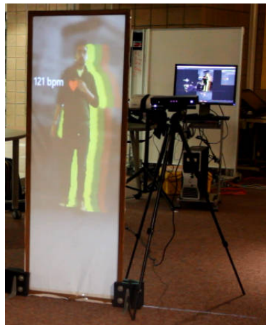
Abbildung 2.5: Anzeigen der Pulsrate auf dem Magic Mirror
