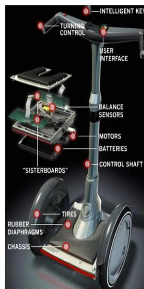
Abbildung 4.2: Aufbau eines Segways (segway, 2008)
