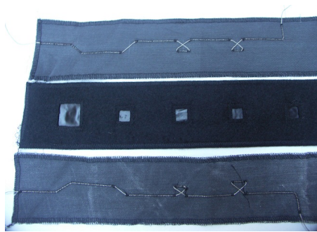
Abbildung 31: Gestickte Sensorfäden mit Velostat-Zwischenlage
