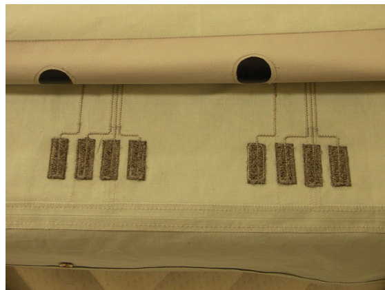
Abbildung 41: Klett-Anschlusselement des Prototyps
