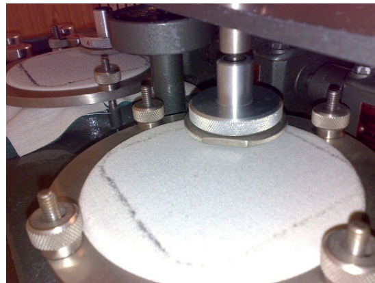
12.2: Flusenablagerung bei der Scheuerprüfung
