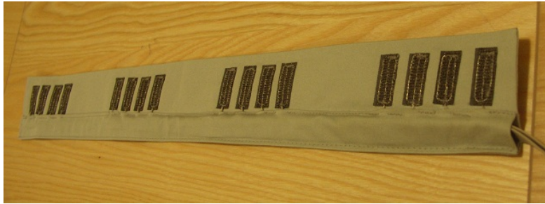
Abbildung 42: Anschlusselement des resistiven Sensors 1
