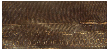
Abbildung 20: Muster verschiedener Stichtypen beim Körper (offen)
