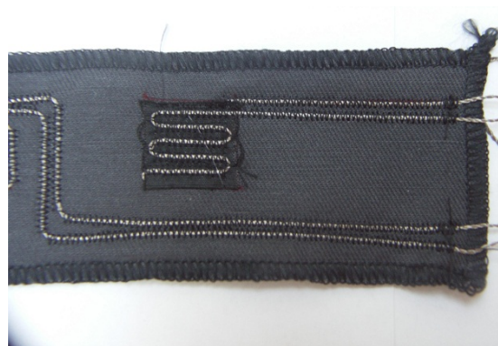
32.2: Mäanderförmige Stickerei mit Zwischenlage
