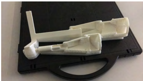
(a) Fertiger Ausdruck des zweiten Prototyps mit Stützstrukturen
