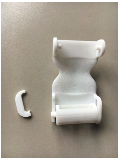
(a) Bruch des Versuchsteils
