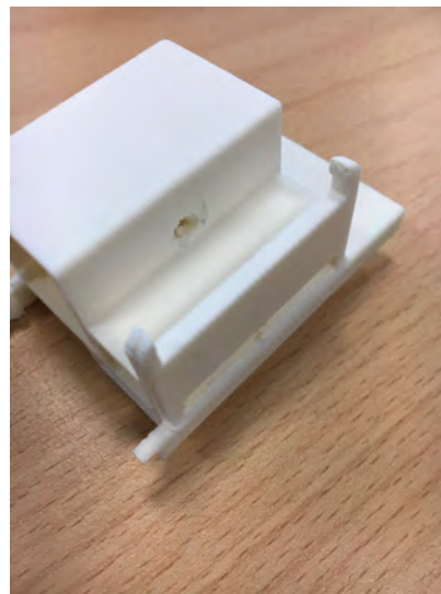
(b) Bruch des Mikrocontrollerhalters
