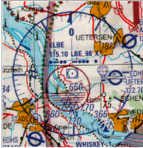
Abbildung 2.3e: UKW-Drehfunkfeuer Elbe auf 115.10 MHz
