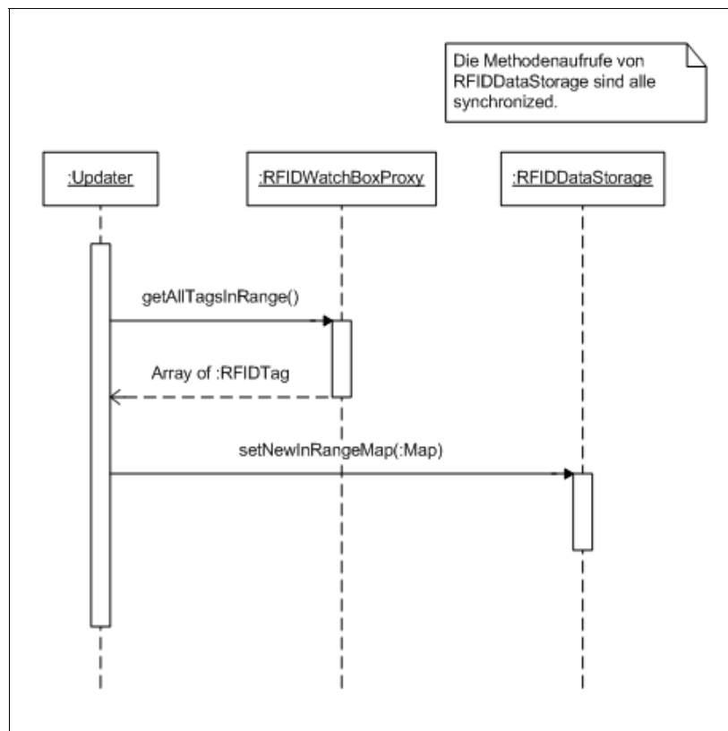
Abbildung 4.2.1.3g: Sequenzdiagramm „Updaten der Tags in Reichweite“
