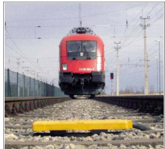
Abbildung 5.2.1a: Eurobalise auf Gleisanlage
