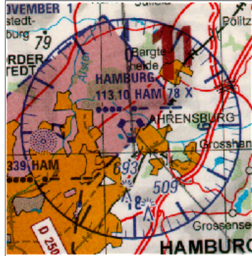
Abbildung 2.3f: UKW-Drehfunkfeuer Hamburg auf 113.10 MHz
