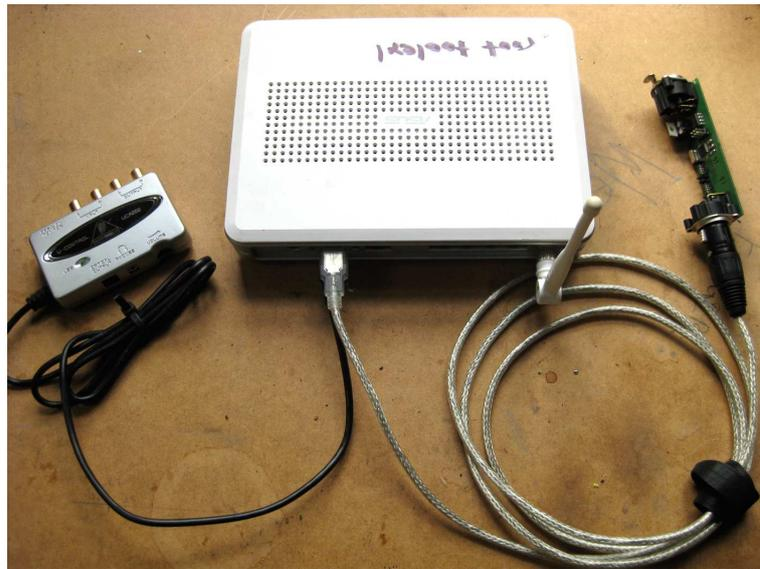
Abbildung 33: Stand Alone Controller: Versuchsaufbau mit Asus WLAN-Router, Behringer USB Soundkarte, Rodin USB-DMX512-Interface und angeschlossenem DMX512-Receiver
