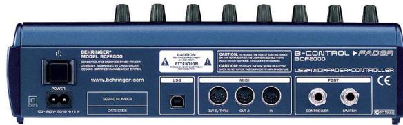
Abbildung 12: Behringer BFC2000 Controller mit USB und MIDI Schnittstellen
