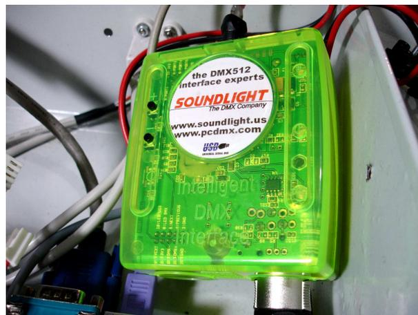
Abbildung 35: USB-DMX512 Interface von Soundlight auf Basis von 8-bit Atmel Microcontroller, Beispiel für kommerzielles "closed-source" Gerät, Quelle: Daniel Hausig, HBK-Saar
