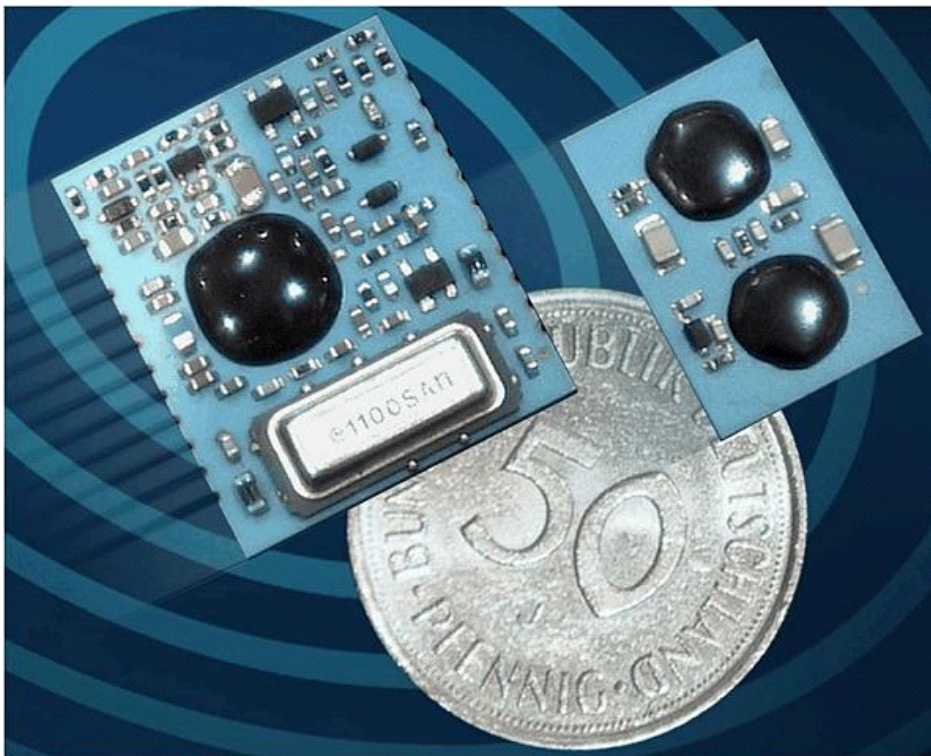
Abbildung 2.3: Größenvergleich: Bluetooth Chip mit 50 Pfennig Stück [14] Links ein aktuelles HF-Modul von National Semiconductor (LMX3162), rechts ein künftiges Komplett-Bluetooth-Modul.
