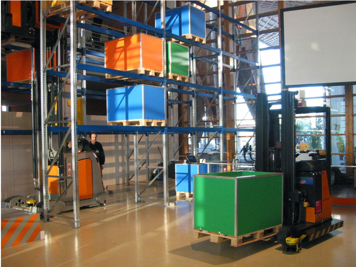
Abbildung 5.1.: Automatisierter Stapler im Hochregallager (Bild von Still GmbH)
