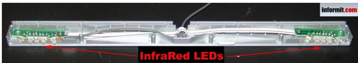
Abbildung 4.23.: Zerlegte Nintendo SensorBar, Bild von „informit.com“
