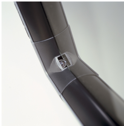
Abbildung 2.5.: SMART DVIT Rahmen mit Kamera
