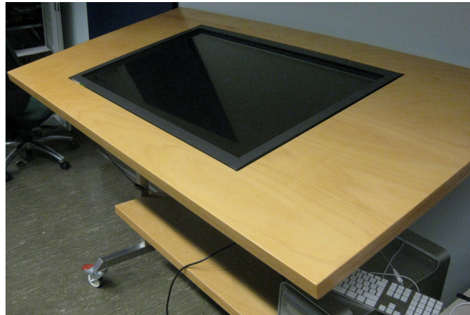
Abbildung 7.1.: Tisch mit eingelassenem Bildschirm und IRTOUCH-Rahmen
