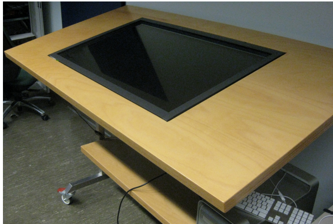
Abbildung 7.1.: Tisch mit eingelassenem Bildschirm und IRTOUCH-Rahmen
