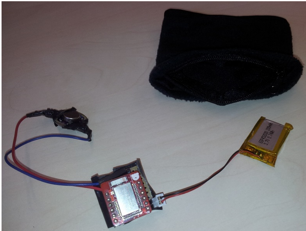
Abbildung 4.6: Nordic nRF51822 SoC, Vibrationsmotor und Akku, welche in das Armband gelegt werden können.
