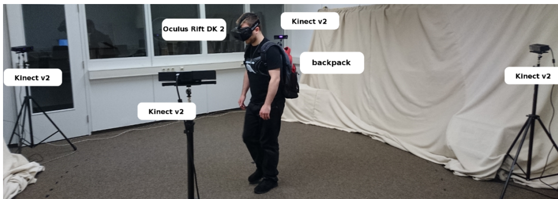
Abbildung 3.3: Versuchsaufbau: Vier Kinects v2 beobachten den Probanden von allen Seiten. Der Proband trägt eine VR-Brille sowie einen Rucksack mit einem Notebook, an das die Brille angeschlossen ist. Langbehn u. a. (2015) .
